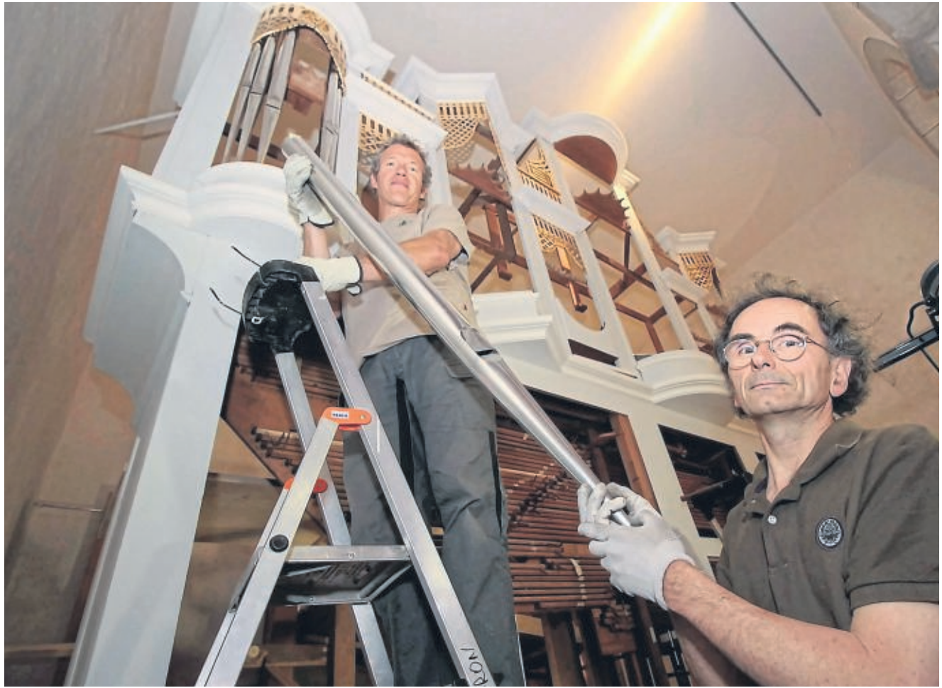
Handschuhe sind ein Muss: Pfeifenbauer Steffen Hartmann (auf der Leiter) und Orgelbauer Andreas Hahn von der Firma Jehmlich Orgelbau aus Dresden bugsieren eine Pfeife aus Zinn an ihren Platz im Orgelprospekt. FOTOS: MORITZ GORNY
