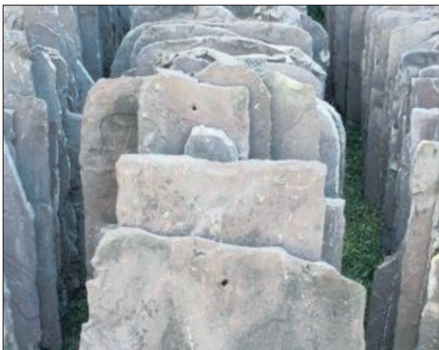
Wertvolles Gut: Die Sandsteine, die zur Dachdeckung des Turms verbaut wurden, sind nur noch über vier Dachdecker in Deutschland erhältlich, da sie in dieser Form nicht mehr produziert werden.
